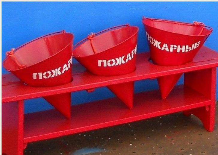
Конусообразные ведра для тушения пожара – это первичная разновидность средства для пожаротушения. Они чаще всего находятся на специальных щитах в сооружениях, зданиях, а также вблизи подобных объектов. Но почему пожарное ведро конусообразное?
